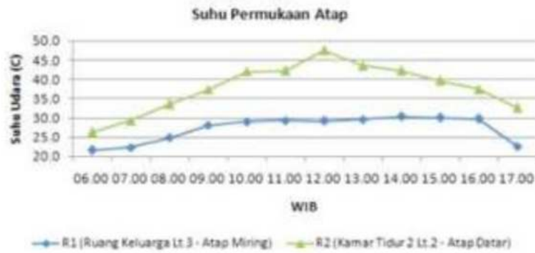
Gambar 5. Grafik hasil pengukuran suhu pada permukaan atap
