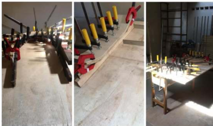
Gambar 1. Proses pengeleman dan bending triplek
