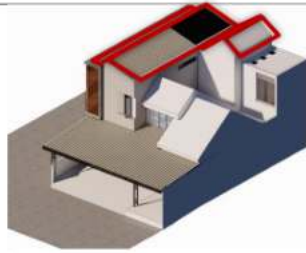
Gambar 12. 3D skematik bangunan eksisting (sebelum redesign )—sisi hadap atas (atap) yang mengalami proses heat transfer radiasi paling besar Sumber: Dokumentasi prbadi, 2022
