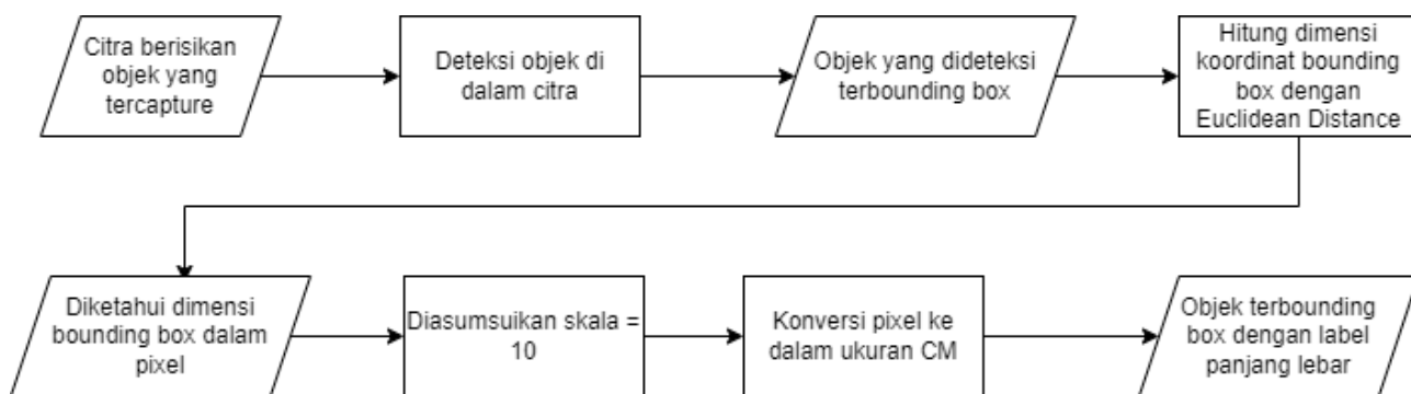
Gambar 1. Alur langkah - langkah pembuatan model
